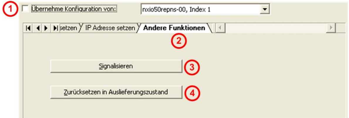
Abbildung 41: Fenster Ethernet-Geräte - Signalisieren, Auslieferungszustand (In der gezeigten Abbildung sind Beispielgeräte zu sehen.)
