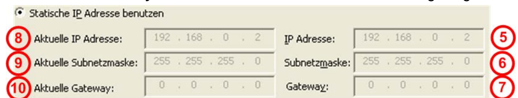
Abbildung 40: Fenster Ethernet-Geräte - Anzeige neue aktuelle IP-Adresse, Subnetzmaske und Gateway-Adresse
